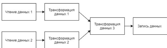
Рис. 2 – Пример конвейера обработки данных, имеющего блоки, которые могут выполняться параллельно
