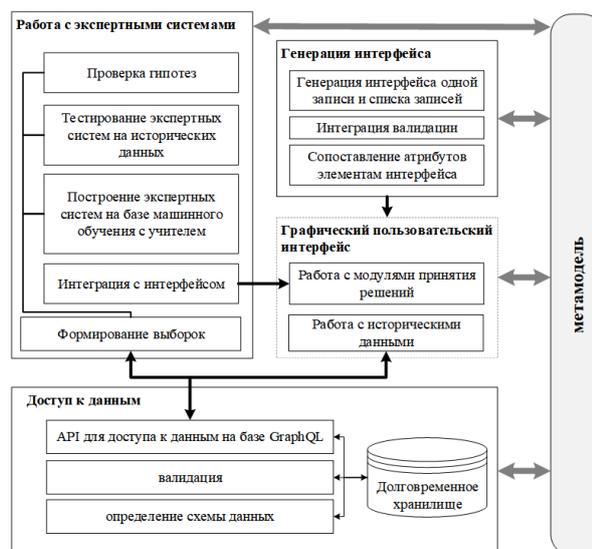
Рис. 1 – Структурная схема основных модулей медицинской информационной системы и их связь с метамоделью
