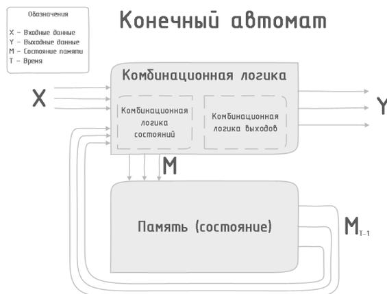
Рис. 1 – Структурно-функциональная схема цифрового конечного автомата
