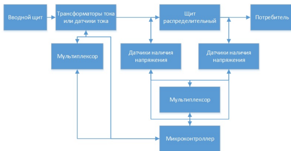
Рис. 3 – Пример структурной схемы системы управления технологическим оборудованием предприятия с использованием датчиков -индикаторов
