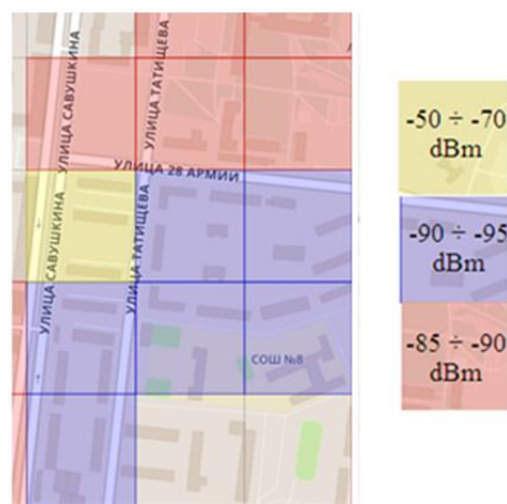
Рис. 2 – Фрагмент карты покрытия с распределением уровня мощности сигнала
