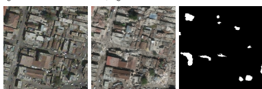
Рис. 3 – Пример обнаружения обрушений
