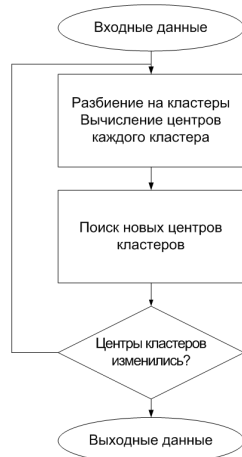
Рис. 1 – Последовательная реализация алгоритма кластеризации
