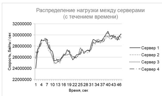
Рис. 4 – Распределение нагрузки между серверами
