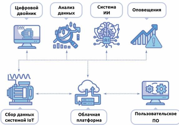
Рис. 2 – Архитектура системы ПдО на с использованием ИИ
