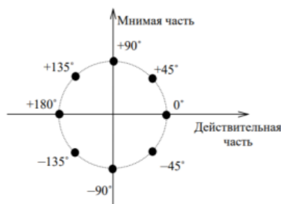
Рис. 3 – Сигнальное созвездие ФМП-8
